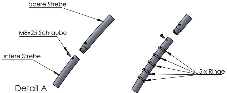
Montieren Sie einen Ring an jeder Panoramastrebe, indem Sie die M8x50 Schraube lösen, die den unteren Teil und den oberen Teil der Strebe zusammen hält. (Detail B)
